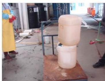
搬運化學品時傾倒洩漏出現之險情
